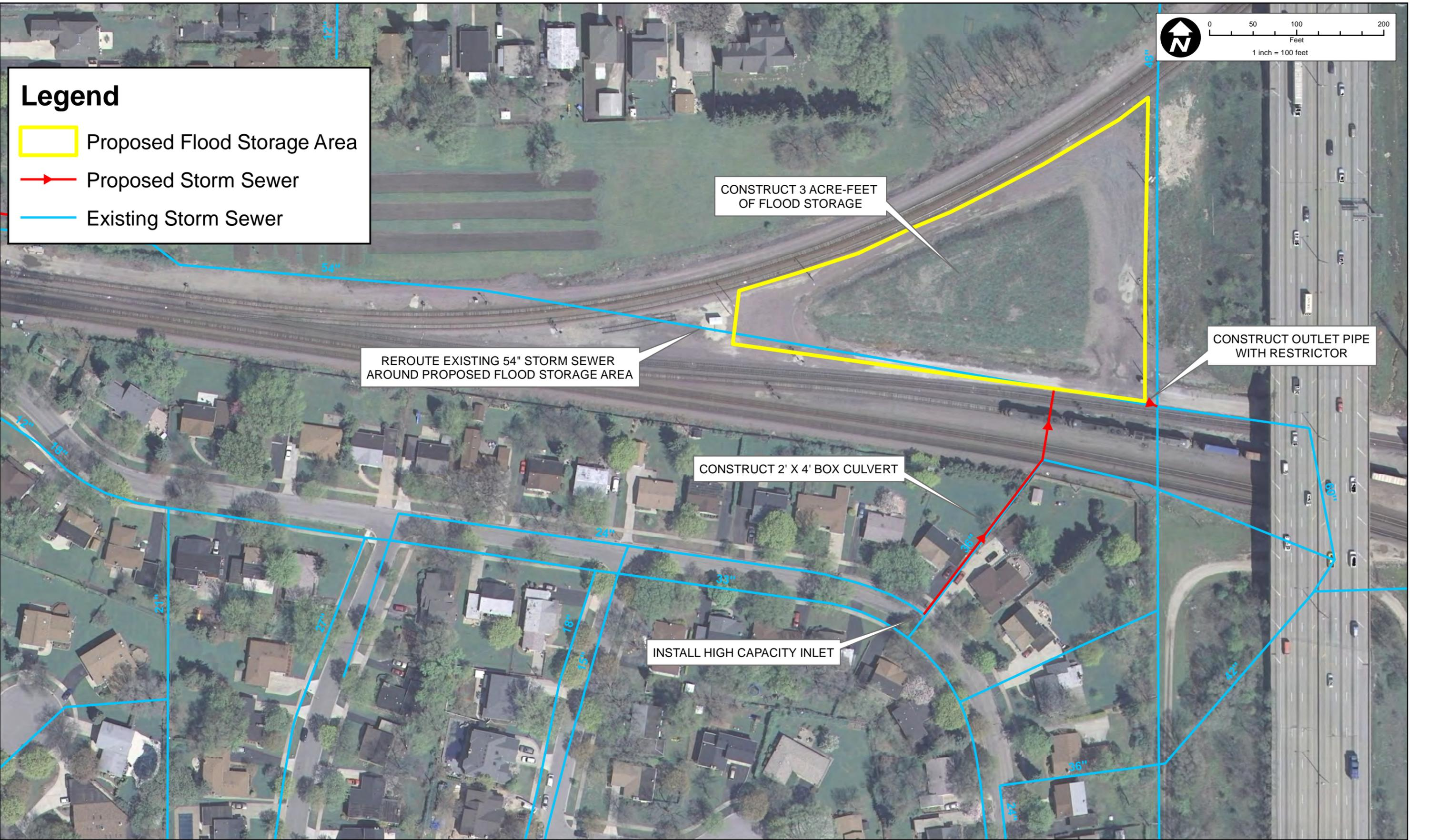
REROUTE EXISTING 54" STORM SEWER AROUND PROPOSED FLOOD STORAGE AREA
